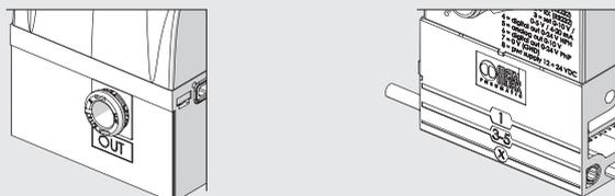
Sortie d'air régulée uniquement par le raccord frontal Ø8.
